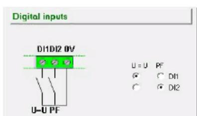
Отметьте цифровой вход, на котором установлена цепь разрешения выравнивания напряжения, чтобы активировать его в программе. Второй цифровой вход резервируется для активации режима регулирования коэффициента мощности.
