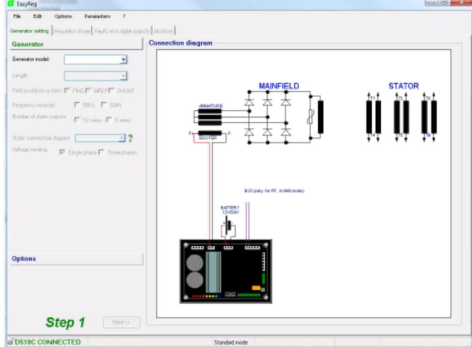
Программирование регулятора выполняется поэтапно. Доступ к странице «Mode de régulation» («Режим регулирования») возможен только при заполненной странице «Configuration Alternateur» («Конфигурация генератора»). Передача конфигурации на D510C из программы выполняется в меню «Печать» затем «ПК-->D510C» или же клавишей F10 клавиатуры.
