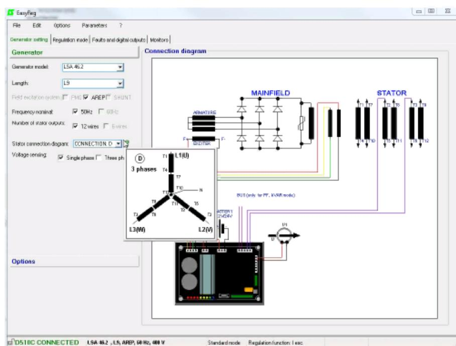
Конфигурация генератора отобразится внизу экрана.
