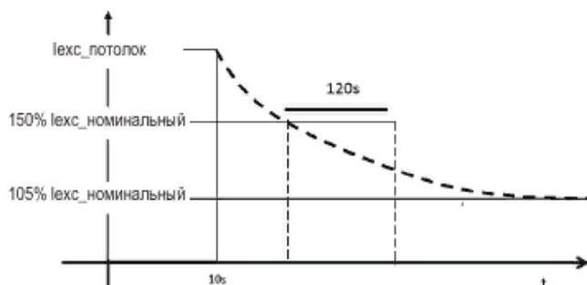
Защита перевозбуждения на кривом предотвращает перезаряд ротора путем ограничения тока возбуждения до 105% от его номинального значения. Задержка активации этой функции зависит от уровня тока возбуждения. Когда ток составляет 150% от номинального тока возбуждения, например, защита ограничивает ток возбуждения после 120с.
