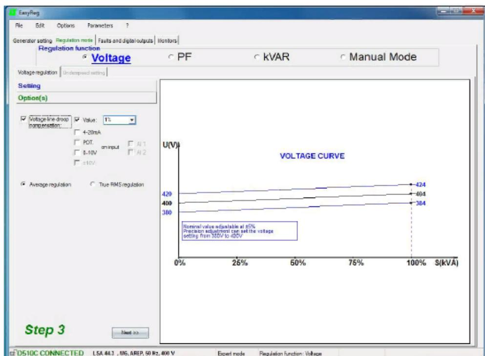
Функция «компенсация падения напряжения в кабеле» не может быть одновременно активирована с функцией «статичность».
